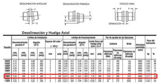
Figura 3. Límites de funcionamiento del acoplamiento utilizado.
