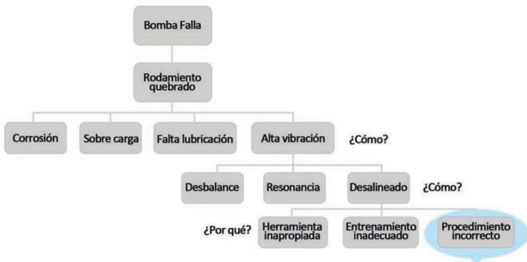
CAUSA-RAÍZ DE LA FALLA
